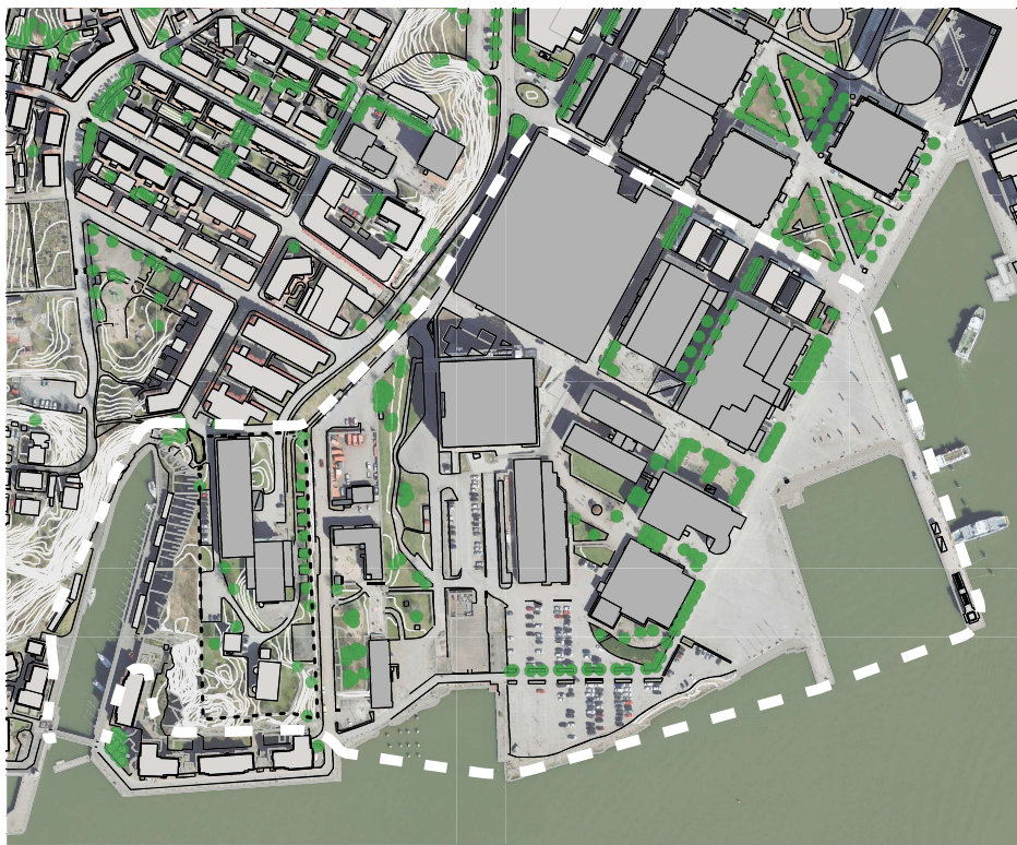
Varvsindustrin har gett området en storskalig prägel, med stora byggnadsvolymer och öppna obebyggda ytor, kajer och lämningar efter stapelbäddar mm. Bebyggelsen är uppförd i nord-sydlig riktning, och senare tillkomna varvshallar i vinkel mot den äldre strukturen. Kartunderlag: Göteborgs stad.
